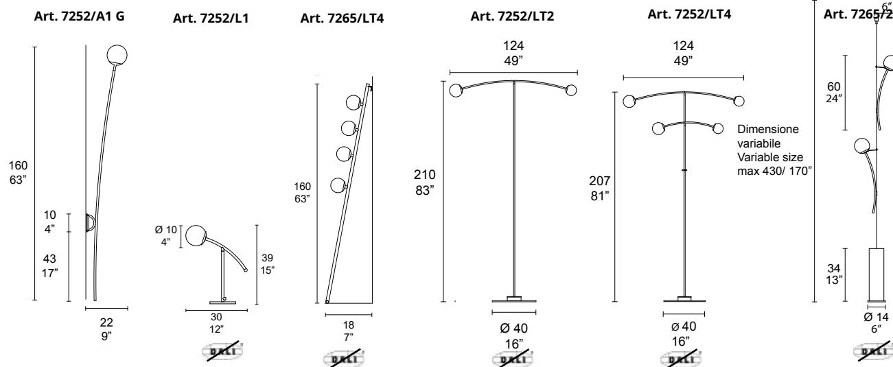
Lampada in metallo, verniciato o trattamento galvanico, con diffusore in PMMA
